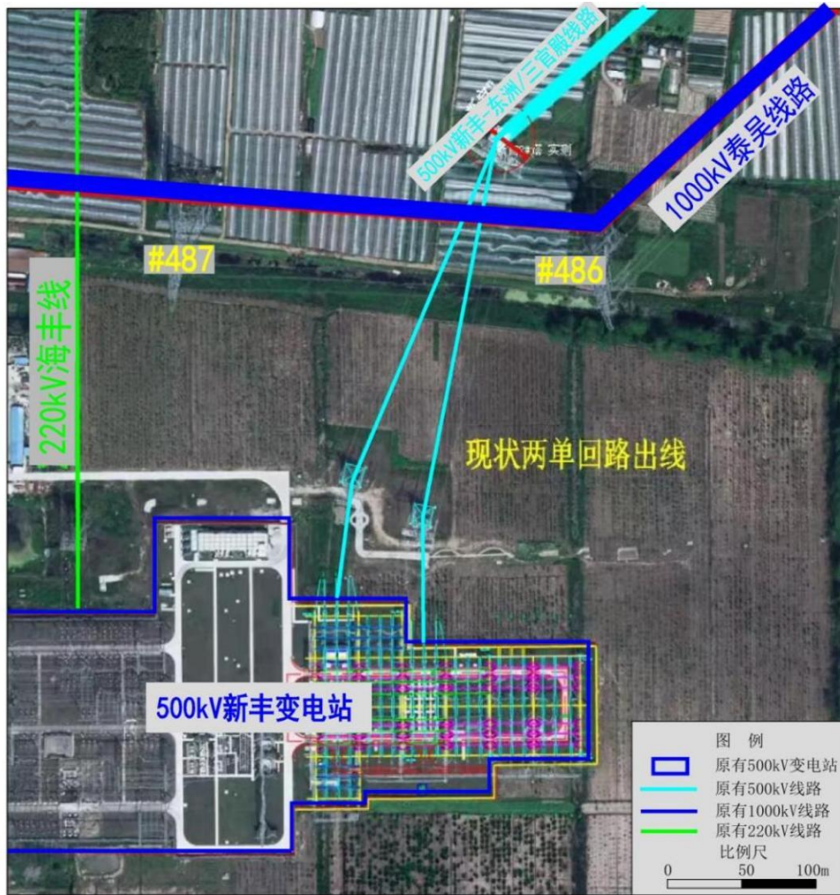
图3.20 现状500kV单回路钻越情况示意图
