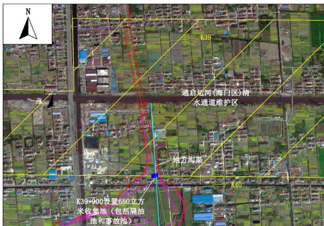
图6.2-3 通启运河（海门区）清水通道区桥面径流收集池
