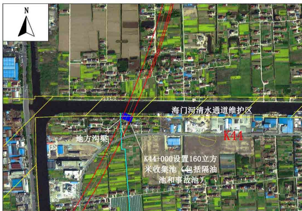
图6.2-2 海门河清水通道区桥面径流收集池
