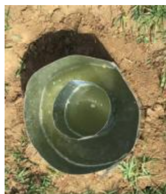
图 5.5-4 渗水试验现场照片
