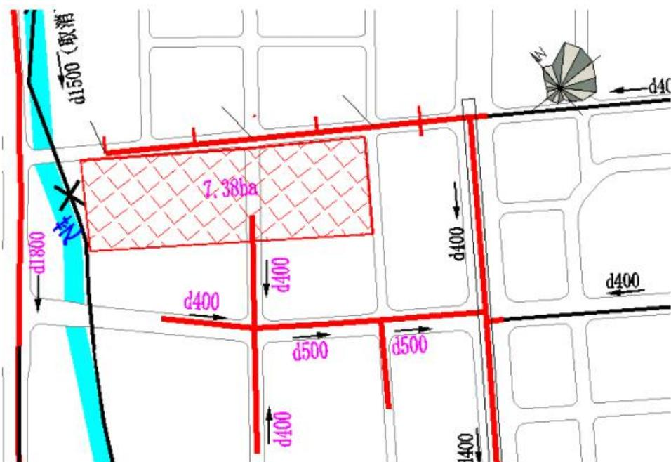
图 1-5 污水管径、服务范围及走向图
