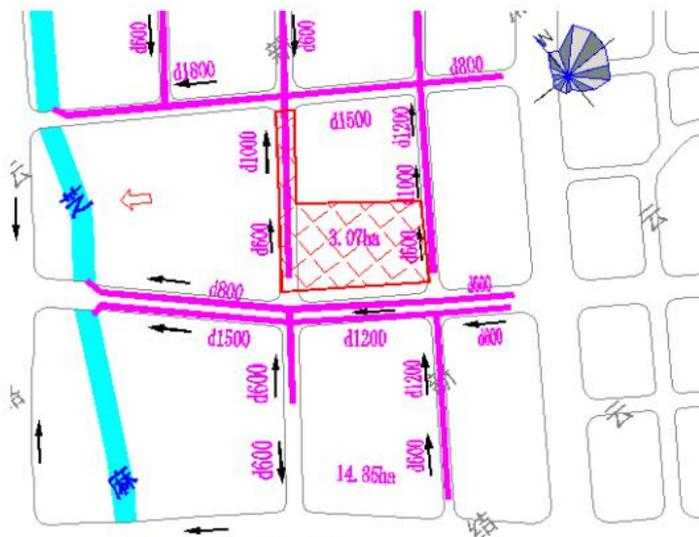
图 1-4 雨水管径、汇水面积及走向图
