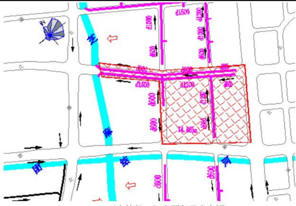
图 1-4 雨水管径、汇水面积及走向图
