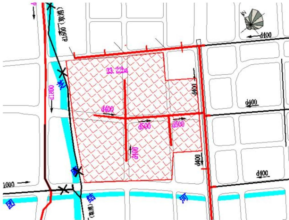
图 1-5 污水管径、服务范围及走向图
