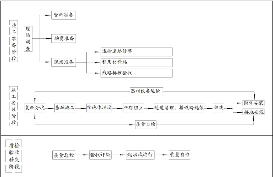
图 3.1-6 新建架空线路施工工艺流程图
