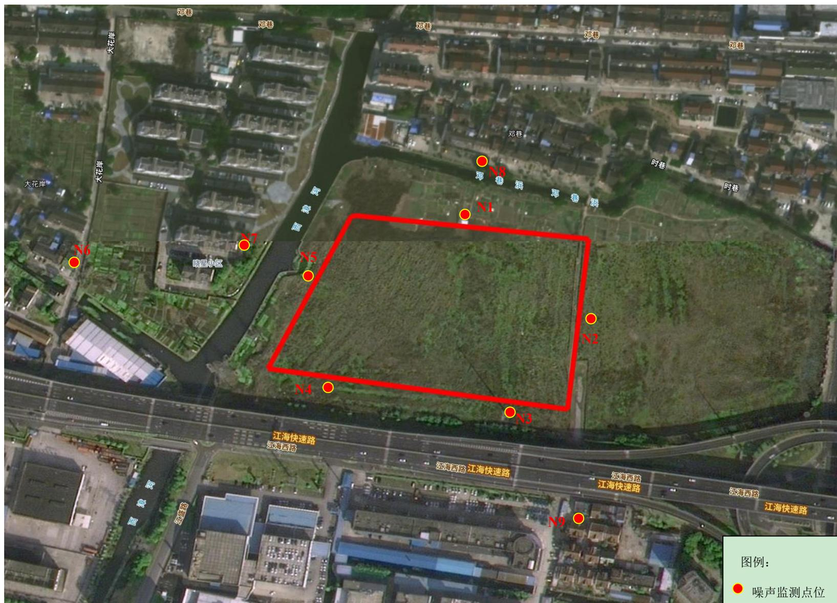
图 4.2-1 建设项目噪声监测点位示意图
