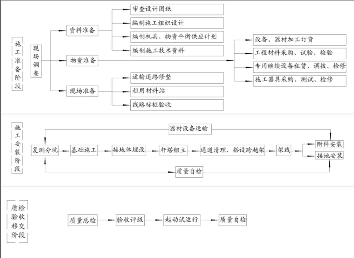
图 3.1-2 新建架空线路施工工艺流程图
