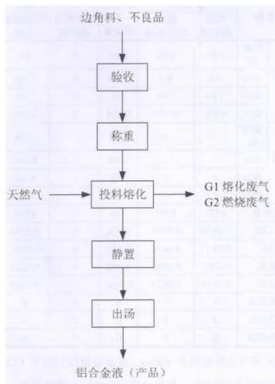
图 3.8-5 3#铝合金生产线铝边角料熔化生产工艺流程图
