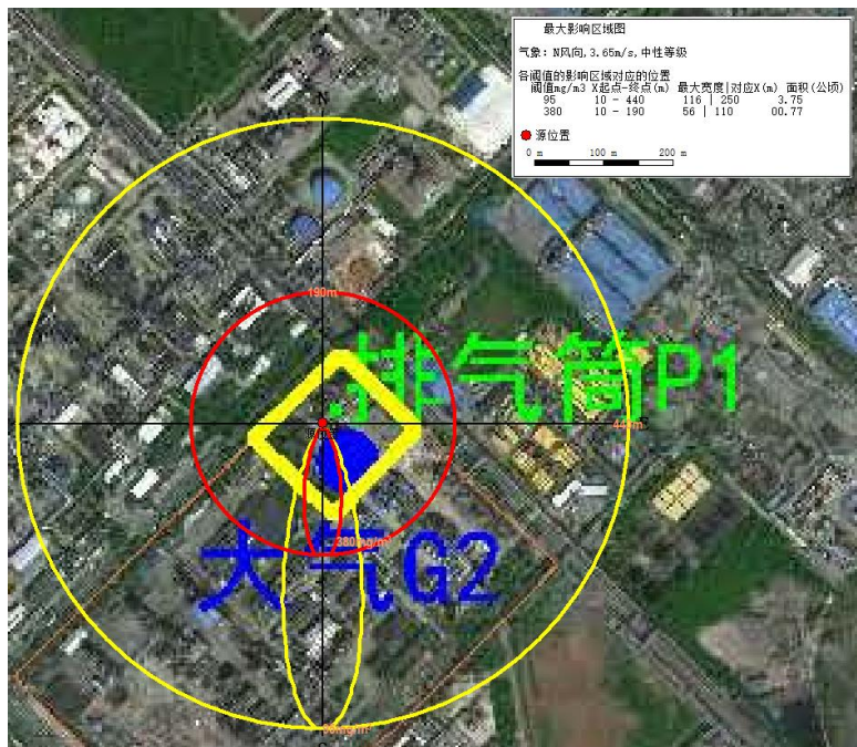
图 6.8.1-4 最常见气象条件下风向（N）CO 浓度分布图（mg/m³）
