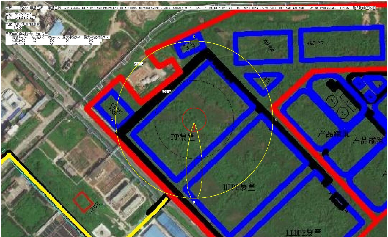
图 6.8.1-4 最常见气象条件下风向（N）丙烯浓度分布图（mg/m 3 ）
