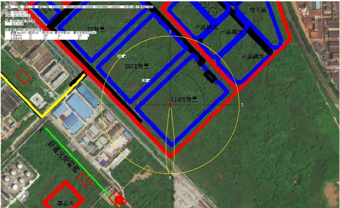
图 6.8.1-2 最常见气象条件下风向 (N) 乙烯浓度分布图 (mg/m³)
