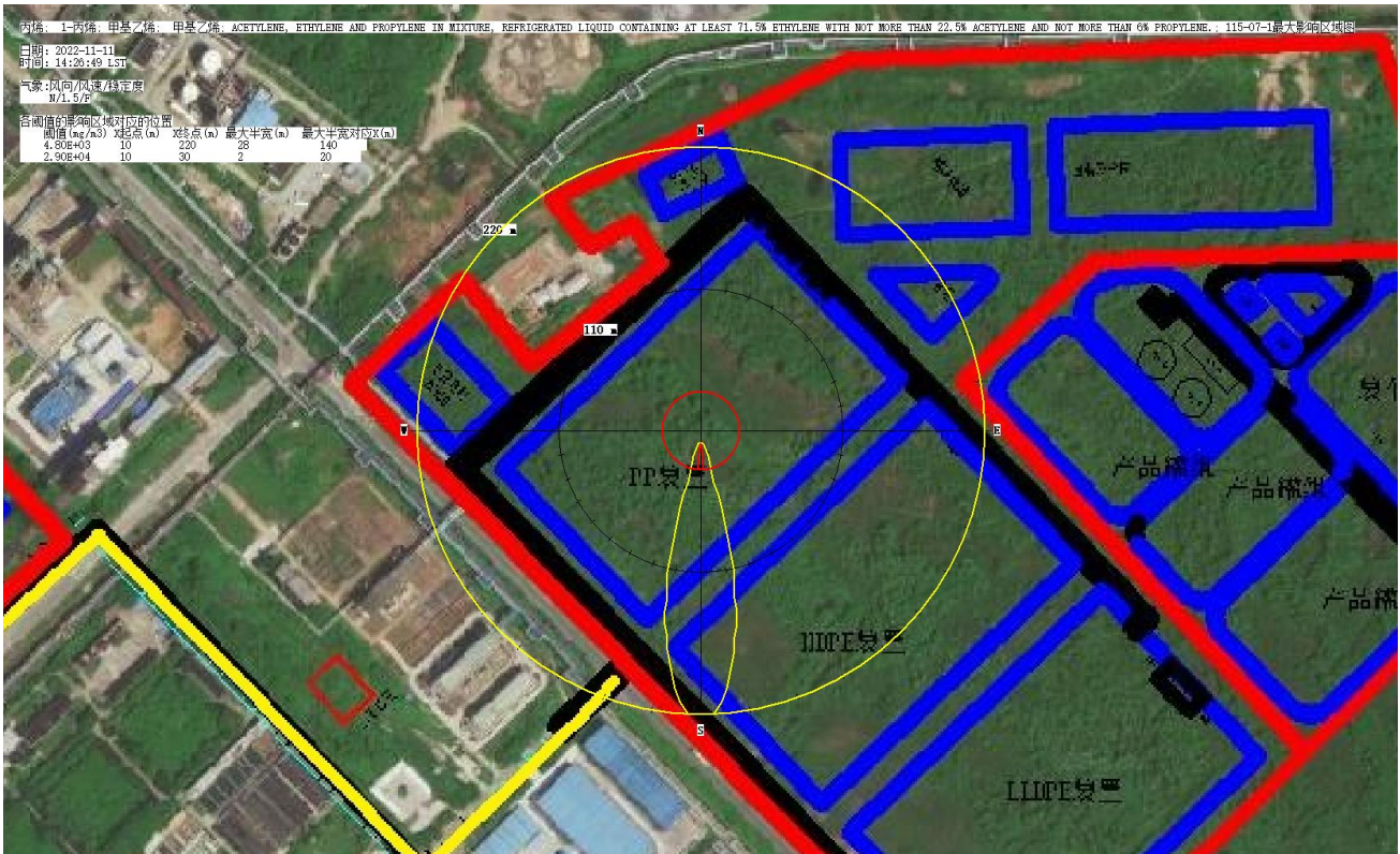
图 6.8.1-3 最不利气象条件下风向（N）丙烯浓度分布图（mg/m 3 ）
