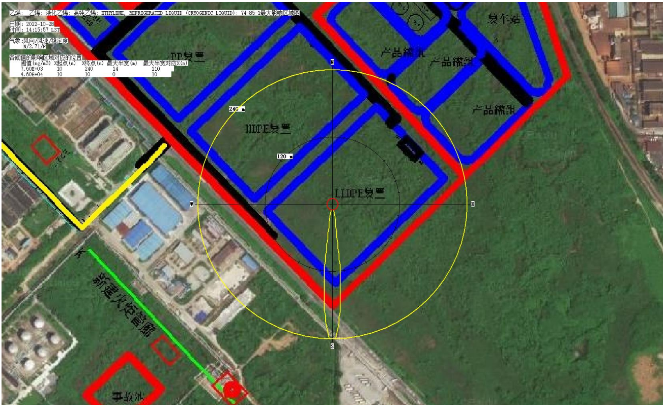
图 6.8.1-1 最不利气象条件下风向 (N) 乙烯浓度分布图 (mg/m³)
